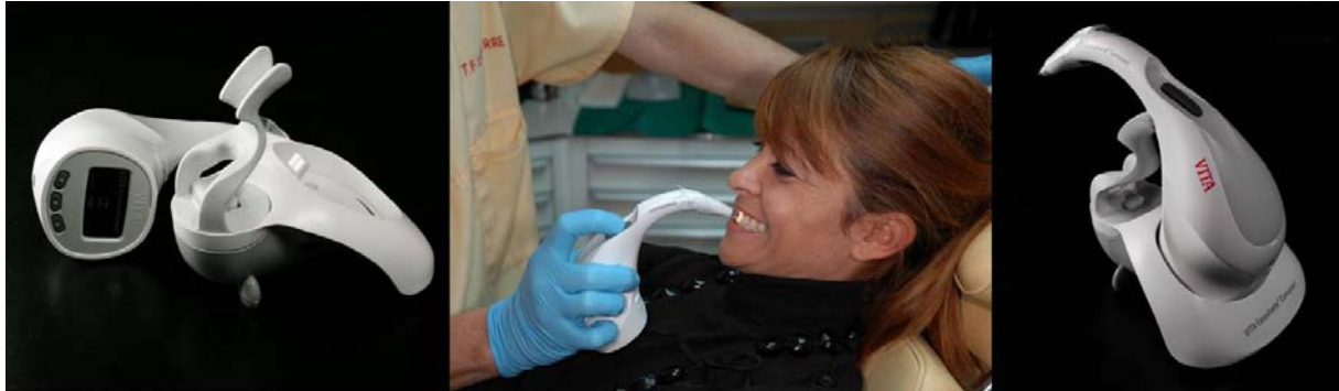
Fig.7: le spectrophotomètre Vita Easy Shade Compact® de Vita et la mesure en spot central dans la zone moyenne de la couronne d'une incisive centrale.
